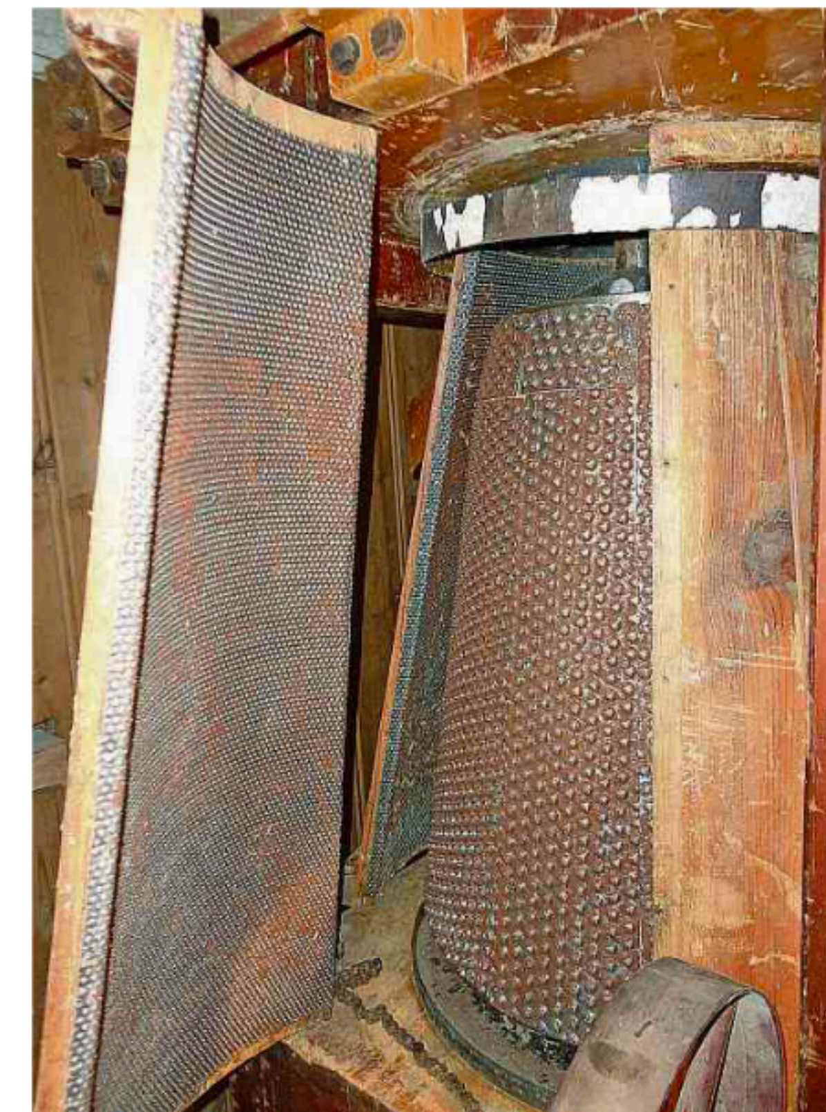
Die Innenseite der Röllmühle sieht aus wie eine grosse Raspel.
