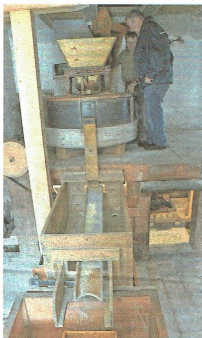
Die Steinmühle in der Maismühle am Grabser Mühlbach.
