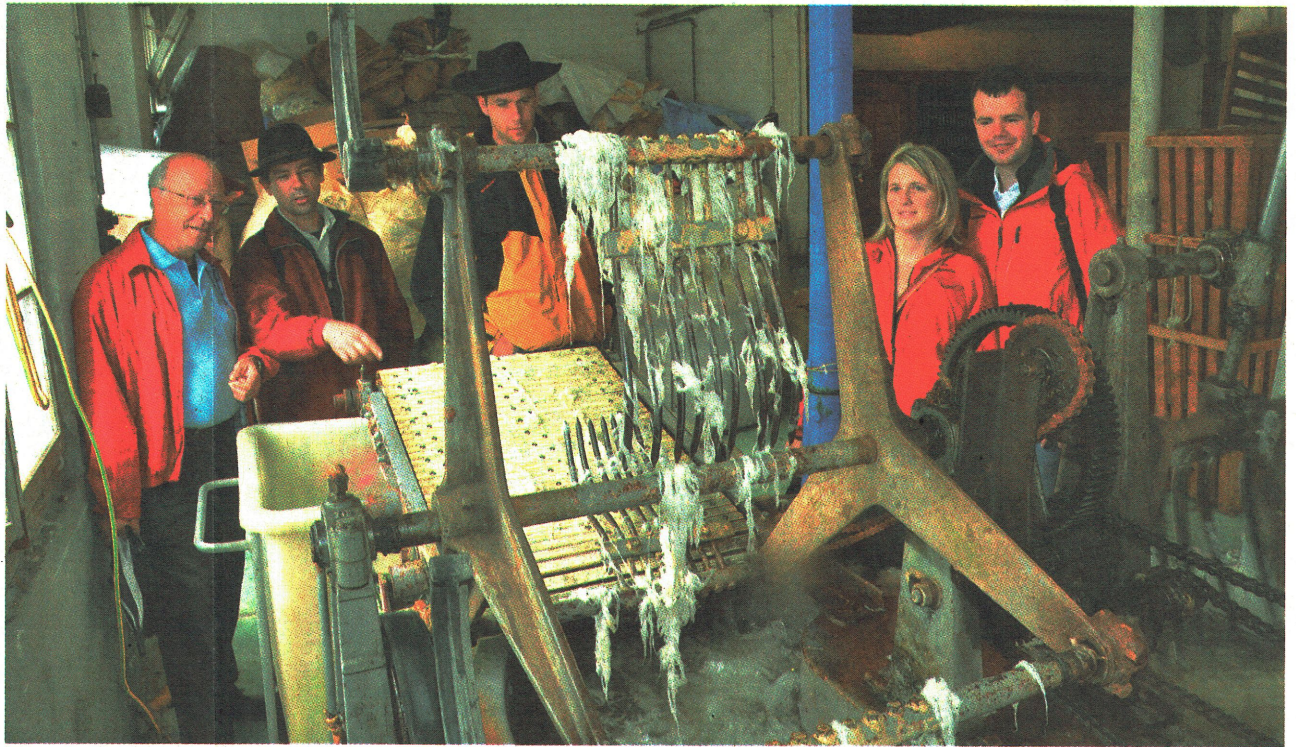
Fachkundig: Mühlbach-Kenner Ueli Weber erklärt «Mühlendoktor» Kurt Fasnacht, Wasserradwagner Simon Oehrli, Ute Kretzschmar und VSM-Präsident Adrian Schürch die Funktion der Schafwollwaschmaschine.
