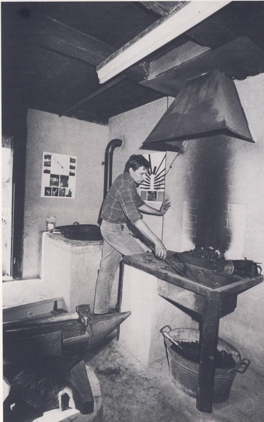
Die restaurierte Esse in Betrieb. Im Hintergrund der Sudhafen zum Auskochen der Kuhhörner.
